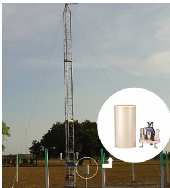
Figura 6: PCD com pluviômetro registrador de sifão basculante. Fonte: NHMET/IEPA.
