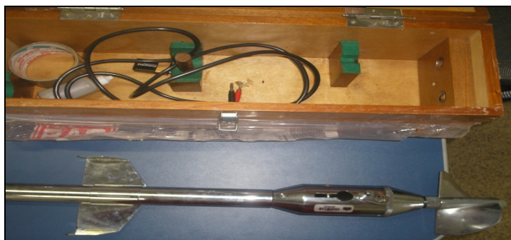
Figura 4 - Molinete Universal Newton utilizado na hidrometria de campo.
