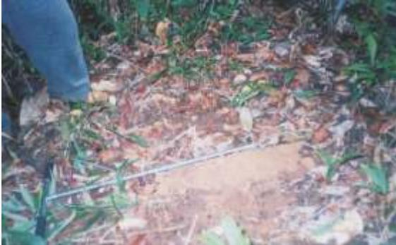
**Figura 36** - Limpeza de materiais superficiais não decompostos no interior de mata primária para tradagem.
