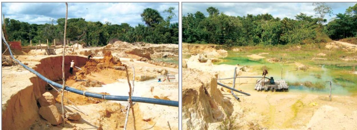
**Figura 4.29** - Extração de seixo e areia em Laranjal do Jari. À direita a área degradada em uma frente de lavra paralisada.
