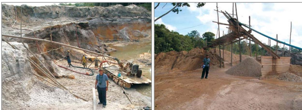
**Figura 4.23** - Frente de lavra de extração seixo (Empresa Extra-Seixo): O minério é dragado em meio aquoso com uso de bomba “chupadeira” (esquerda) e, a seguir é selecionado com o uso de uma tela/peneira (direita). Fotos: IEPA/SEICOM.
