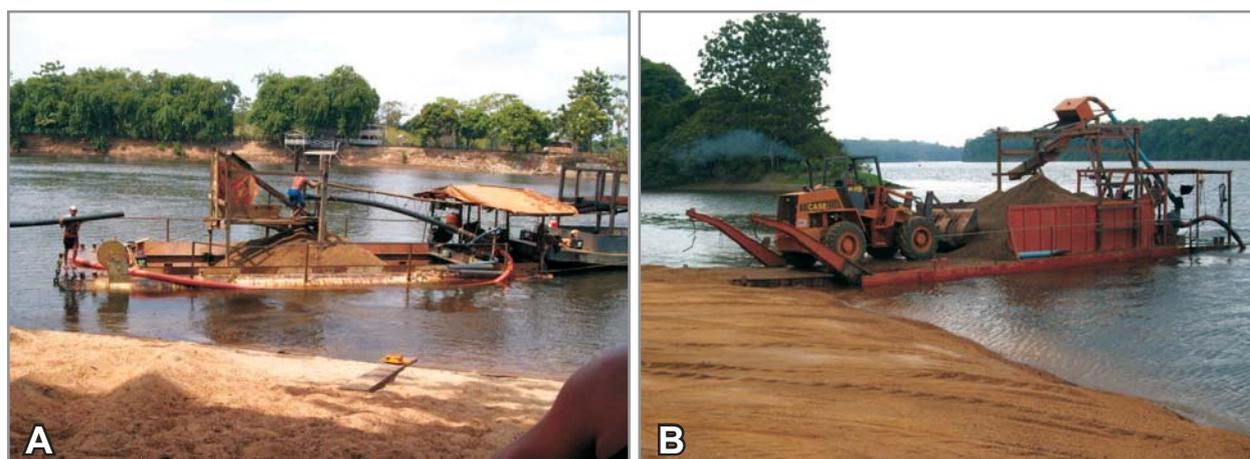
**Figura 4.26** - (A) Balsa chegando para desembarque na margem do rio Araguari após procedimento de lavra no fundo do canal. (B) Outro modelo de balsa, onde o desembarque do minério é realizado com pá carregadeira. Fotos: DGRH/IEPA e SEICOM.
