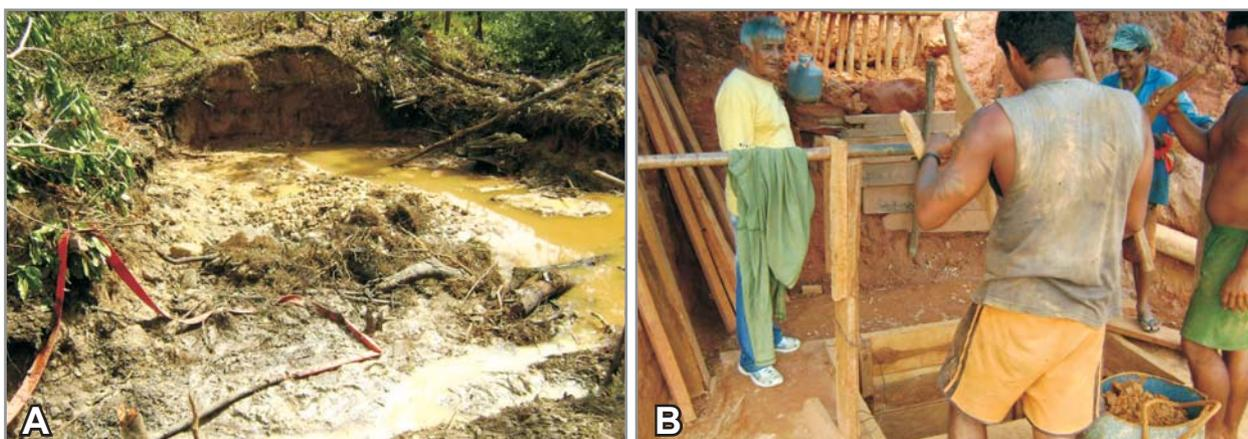
**Figura 4.35** - Atividades desenvolvidas no garimpo do Cassiporé: (A) Retirada de material aluvionar do leito e margem de igarapé; (B) Retirada de material através de shaft.
