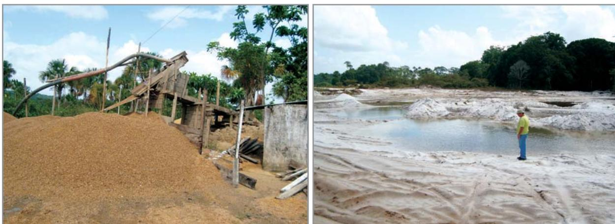
**Figura 4.30** - Extração de seixo em leito de rio no município de Oiapoque (L. R. Silva - ME). À direita, extração de areia (terra firme) em Oiapoque - Areal do Artur.
