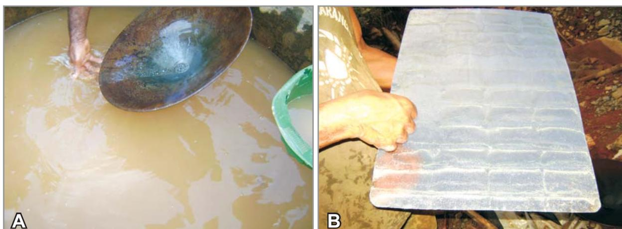
**Figura 4.41** - Mercúrio na atividade garimpeira: (A) Uso do mercúrio para a amalgamação do ouro em bateia. (B) Uso do mercúrio nas placas de cobre para a retenção do ouro.
