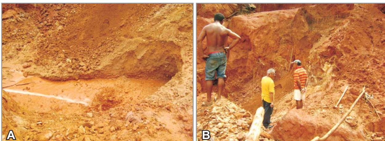
**Figura 4.38** - Frentes de trabalho do garimpo do Capivara: (A) Desmonte de material coluvionar da encosta de morro. (B) Frente de lavra aberta para retirada de veio de quartzo mineralizado.
