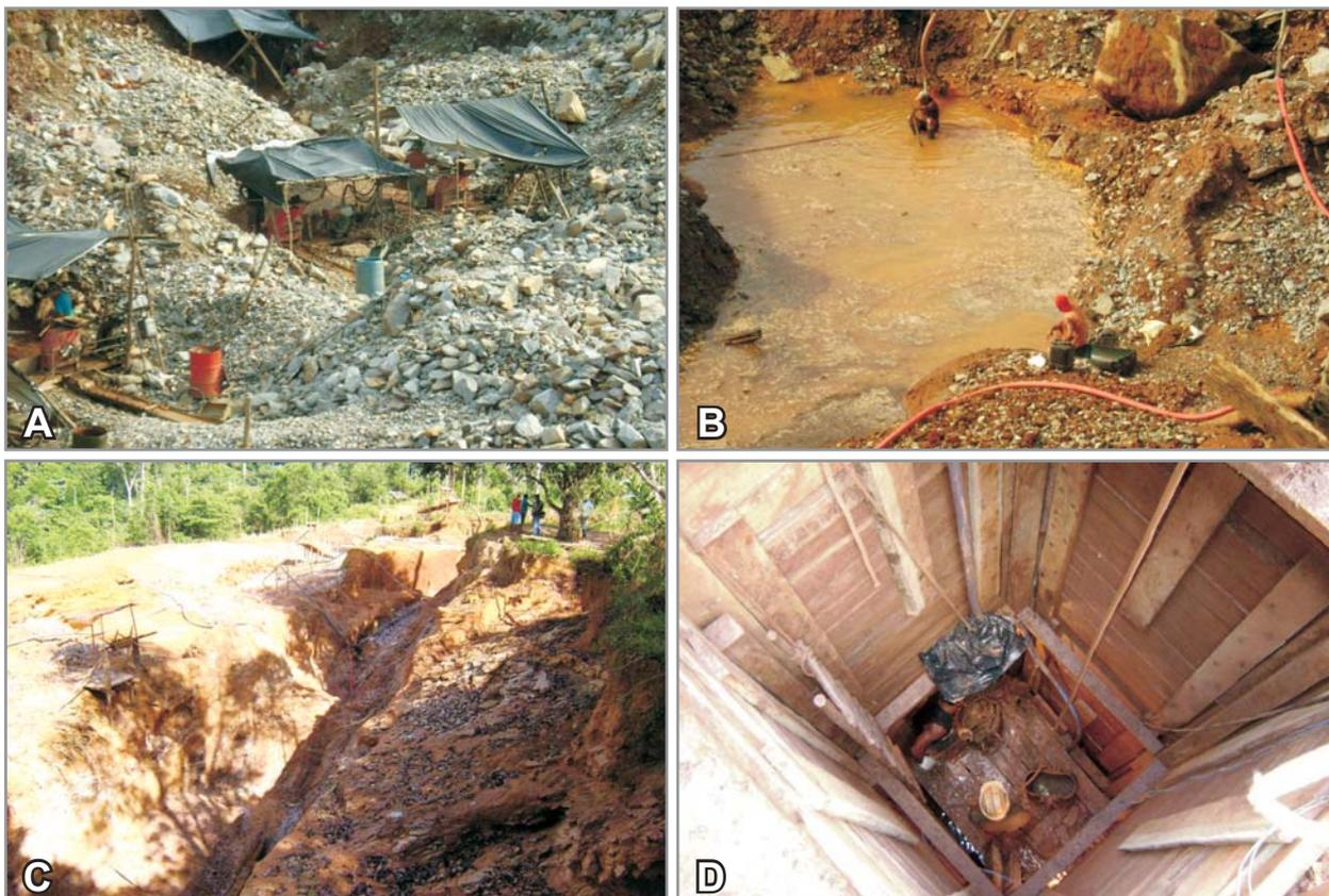
**Figura 4.34** - Atividades desenvolvidas no garimpo do Lourenço. (A) Rejeitos (Fragmentos de rocha) retirados da mina para moagem. (B) Lavagem de material trabalhado anteriormente pelos garimpeiros. (C) Desmorte Hidráulico em encosta de morro. (D) Abertura de shaft.
